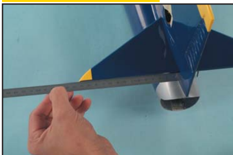
...puis de l'autre. ● Positionner l'empennage jusqu'à obtenir la même distance des 2 côtés. ● Immobiliser l'empennage à l'arrière avec 2 épingles.
