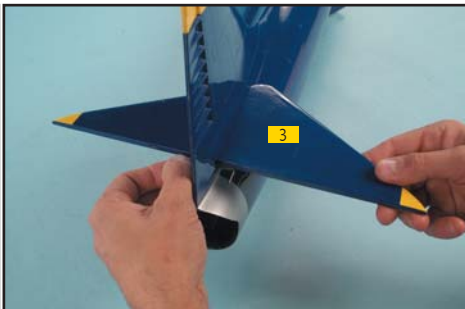
● Passer délicatement le stab. 3 débarrassé des volets de profondeur dans la fente pratiquée à l'arrière du fuselage. Notez la position de la pièce CAP de jonction des volets de profondeur.
