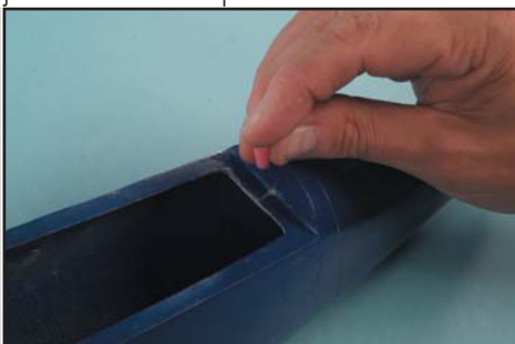
● Ensuite trianguler. Pour cela, planter une épingle de modéliste au centre du fuso à l'avant.
